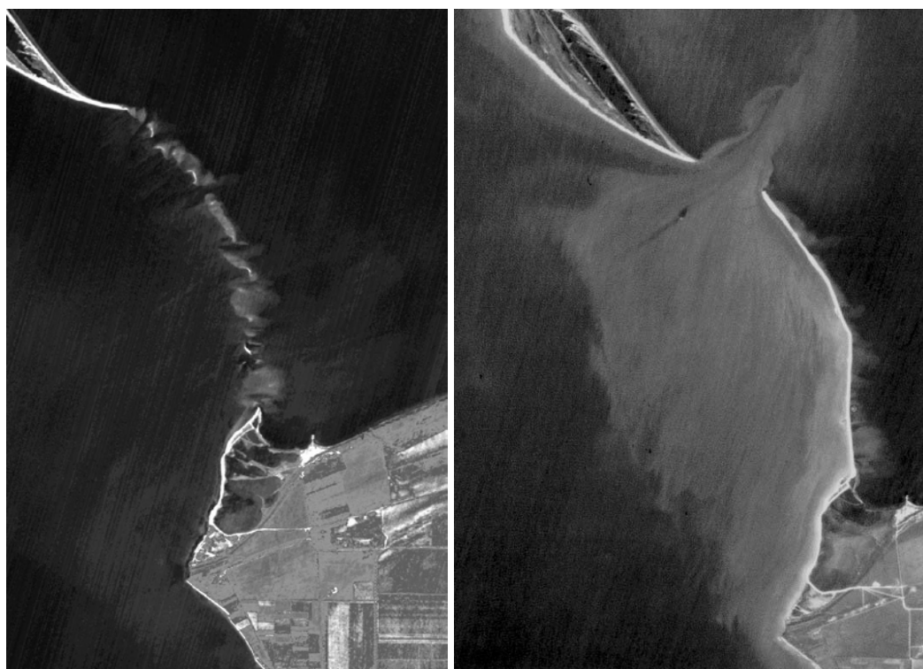
Рисунок 7.10 – Коса Тузла до и после отсыпки дамбы в 2003 г. (космический снимок с сервиса Яндекс-карты)
