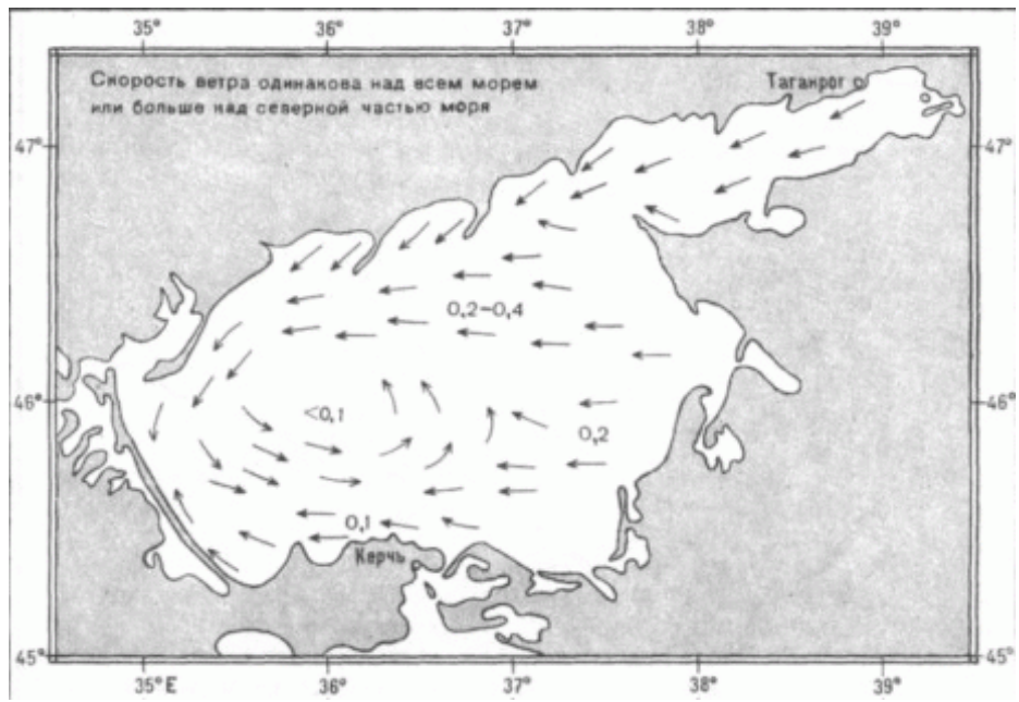
Рисунок 7.4 – Схема течений при СВ и В умеренных ветрах одинаковых над всем морем
