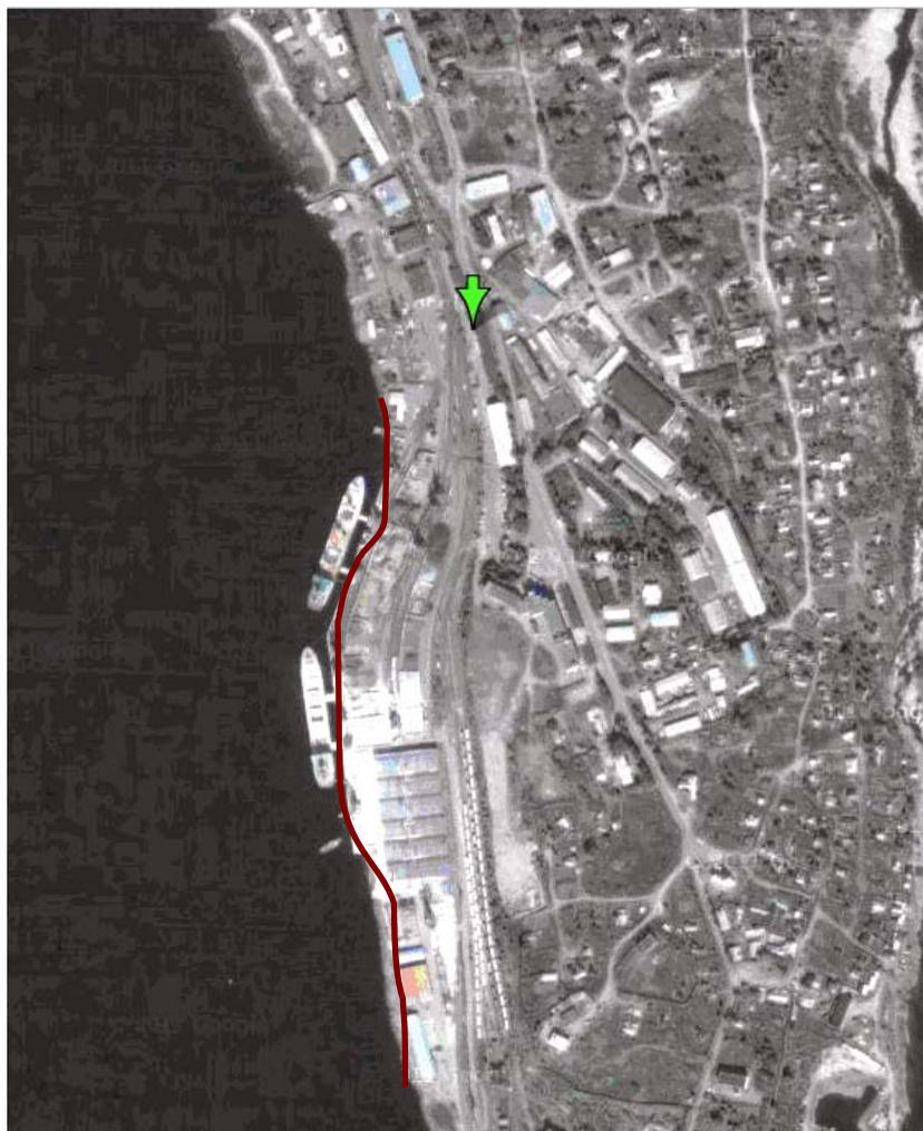
Рисунок 3.47 - Техногенный тип берега. Район Кандалакшского порта. Закрепленные берега в виде бетонных стенок (Google Earth).
