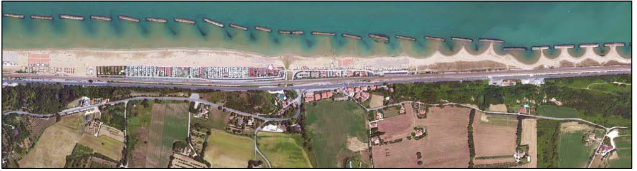
Рисунок 10.59 – Примеры применения прерывистых волноломов для защиты рекреационных песчаных пляжей на Адриатическом побережье Италии. Видны участки вариантов расположения волноломов с формированием томболо (справа) и без (слева)
