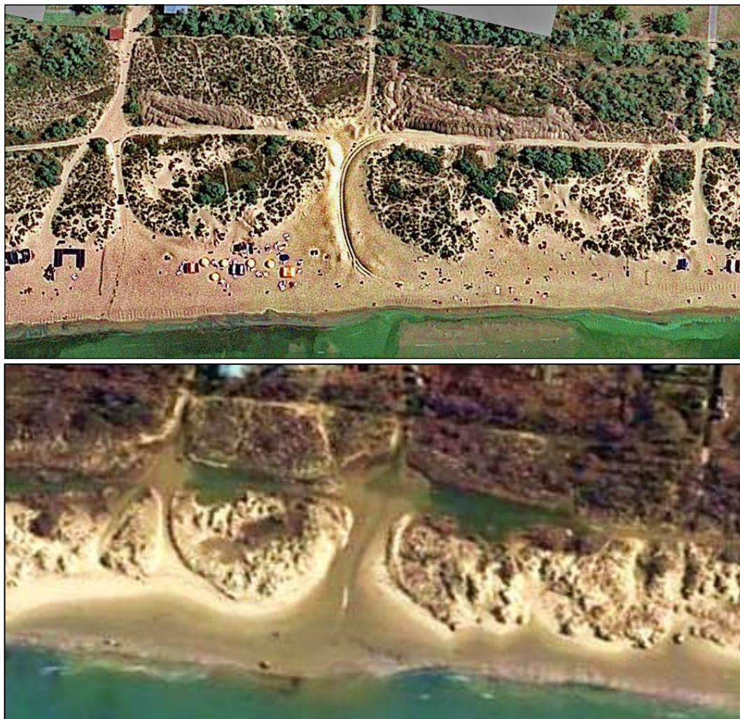
Рисунок 10.51 – Прокладка прорезей через дюны (вверху) нарушает рельеф и растительный покров, при экстремальных штормах на этих участках отмечается перехлестывание волн и образование в тыльной части временных озер (внизу) [maps.yandex.ru; Google Earth]
