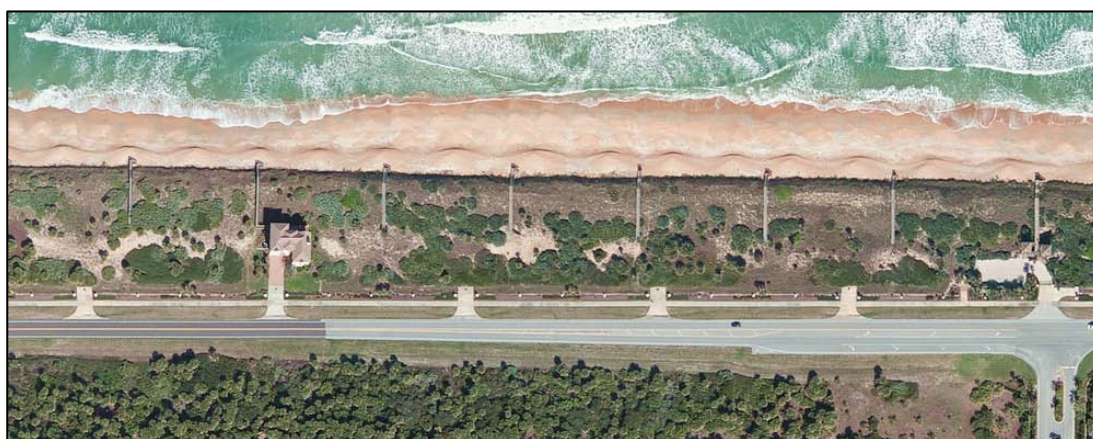
Рисунок 10.60 – Примеры организации пешеходных выходов на пляж через авантюну на побережье Флориды. Расстояние между соседними переходами – 50-60 м
