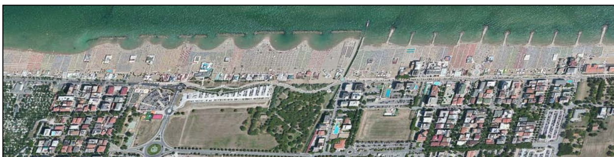
Рисунок 10.58 – Примеры вариантов защиты рекреационных песчаных пляжей на Адриатическом побережье Италии. Видны участки без защиты (слева), с каменно-набросными прерывистыми волноломами (в центре) и бунами (справа)
