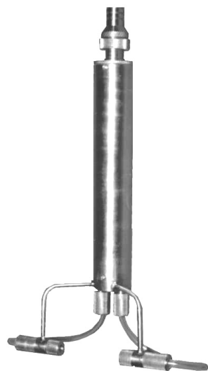
Рис. 1.3. Внешний вид погружаемого блока турбидиметра
