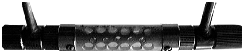
Рис. 1.11. Внешний вид измерительной головки турбидиметра с фильтром
