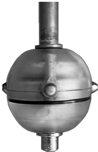
Рис. 1.17. Внешний вид экспериментального образца измерительной головки электромагнитного датчика течений
