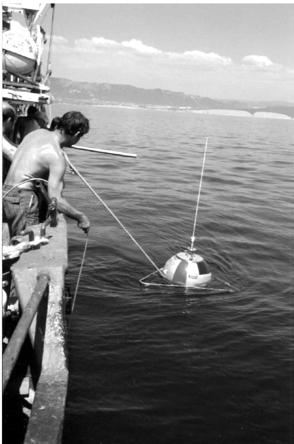
Рис. 1.28. Фрагмент постановки буя с научно-исследовательского судна. На заднем плане – береговая линия
