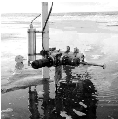
Рис. 2.8. Стальная труба с установленными на нее турбидиметром, измерителем скорости потока и датчиком давления
