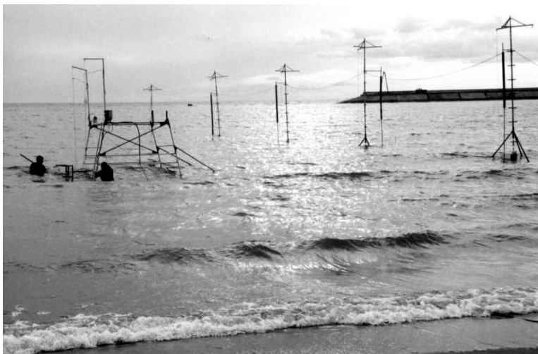
Рис. 2.19. Вид на створ установки стационарных приборов (справа) и на створ, вдоль которого производилось перемещение подвижных “саней”
