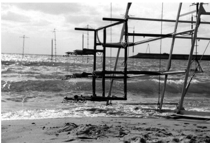
Рис. 2.17. Вид на турбидиметры, датчики течений и волнографы, установленные на подвижных санях
