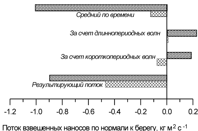
Рис. 8.14. Измеренные (красный цвет) и рассчитанные по модели Бэйларда потоки взвешенных наносов (синий цвет). Эксперимент “Нордерней-94” (Северное море). Условия измерений: высота значительных волн – 1.42 \text{ м} , период пика спектра – 9.8 \text{ с} , глубина – 2.30 \text{ м} . Дно плоское. Скорость противотечения - \langle U^- \rangle = -0.40 \text{ м/с} .
