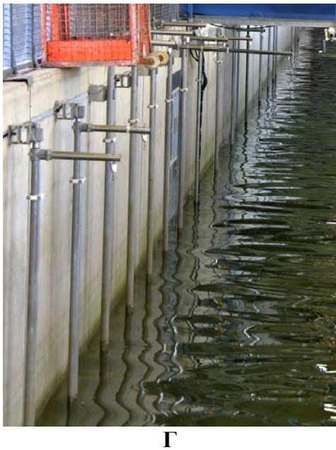
Рис. 2.1. Основное оборудование, использованное во время эксперимента «Ганновер’ 2006»: турбидиметр (А); «Вектор» (Б); 2-х компонентный электромагнитный датчик скорости течения (В); струнные волнографы (Г); наносонакопители (Д); видеочамера (Е).
