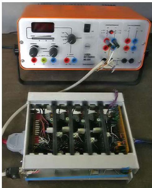
Рис. 4. Бортовой блок обработки сигналов с турбидиметров (А), фрагменты соединительных кабелей с промежуточными разъемами (Б).
