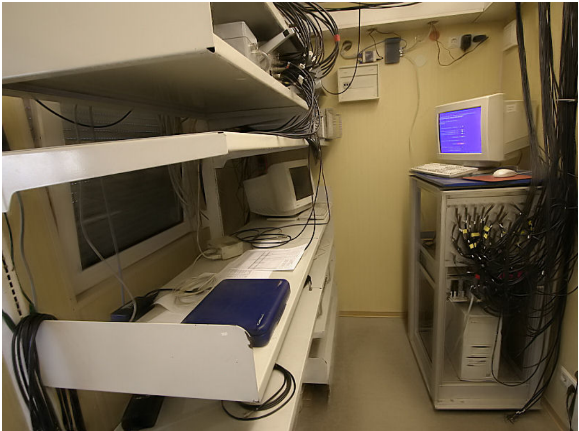
Рис. 2.3. Фотография вычислительного центра сбора информации с 80-и канальным АЦП параллельного ввода.
