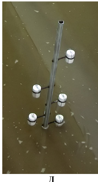
Рис. 2.1. Основное оборудование, использованное во время эксперимента «Ганновер’ 2006»: турбидиметр (А); «Вектор» (Б); 2-х компонентный электромагнитный датчик скорости течения (В); струнные волнографы (Г); наносонакопители (Д); видеочамера (Е).
